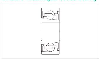
ラジアル荷重と一方向のアキシアル荷重を負荷することができるミニチュア玉軸受。アキシアル負荷能力が高く、負荷を受ける側の内輪および外輪の溝は深い。接触角を45°にして、アキシアル剛性が大きい。両側が鋼板でシールドされ、グリースが封入されている。通常2個の軸受を対向させ、内部すきまを調整して使用する。ボールねじ支持用に適する。
