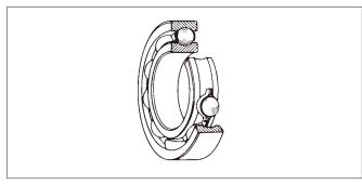
内輪・外輪に設けられた軌道の溝は、転動する玉の半径より、わずかに大きい半径の円孤の横断面をなしているラジアル玉軸受である。 ラジアル荷重のほかに、両方向のアキシアル荷重を負荷することができる。 摩擦トルクが小さく、高速回転をする箇所や低騒音・低振動が要求される用途に最も適している。
