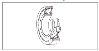
潤滑グリースの漏れや異物の浸入を防ぐため、シール又はシールドを付けた深溝玉軸受である。これらの軸受の片側又は両側にはシール又はシールドが付いている。両シール又は両シールド軸受には良好な潤滑グリースがあらかじめ封入されている。
