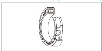
内径に対する外径の比が標準より小さい深溝玉軸受である。この 軸受を使用することにより、装置の小形軽量化が図れる。
