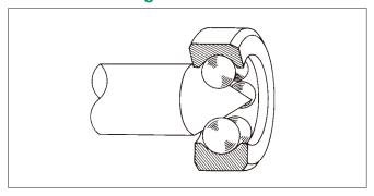
外輪及び数個の玉から成り,回転軸の先端の円すい部(通常60°の ピボット)を支える玉軸受である。玉のピッチ径が小さいことと軸の ピボット部の形状から,摩擦トルクは小さい。
