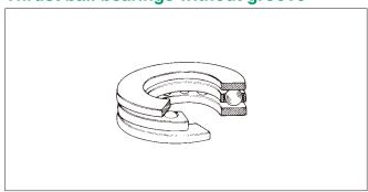
軌道みぞのない平らな軌道盤と、玉を組み込んだ保持器から構成されている。一方向のアキシアル荷重だけを負荷することができる。 軌道が平面なので、摩擦トルクは小さい。低速回転に用いられる。
