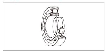
内輪幅を外輪幅より0.397mm(1/64インチ)ずつ両側に拡げたインチ系の深溝玉軸受である。この軸受を使用すると,軸受周りの設計や組立てが簡単になる。
