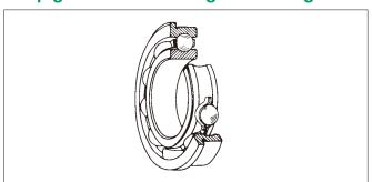
外輪の片側につばをもった深溝玉軸受である。この軸受を使用する場合,ハウジング内径に肩を設ける必要がないので,精度の高い通し穴加工ができる。
